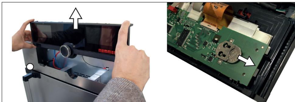
Fig. 29 Rimuovere la batteria al litio
