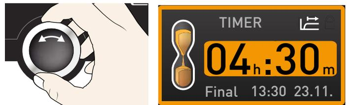
**i** El tiempo se muestra con el formato hh:mm (horas:minutos) hasta una duración de 23 horas y 59 minutos; a partir de 24 horas el formato cambia a dd:hh (días:horas). El tiempo de duración máximo son 99 días y 00 horas.
