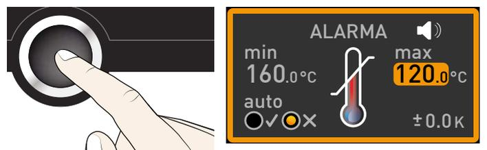
4. Ajuste el límite superior de alarma deseado con el botón giratorio, en el ejemplo de la derecha 190 °C.
