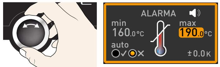
**i** La temperatura de control debe ajustarse con suficiente margen sobre la temperatura nominal máxima. Se recomienda entre 5 y 10 K.
