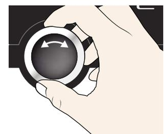
▶ Para ampliar o reducir los gráficos: Presionar la tecla de activación junto al símbolo de la lupa, seleccionar con el botón giratorio si desea ampliar o reducir la representación (+/-) y aceptar la selección con la tecla de confirmación.
