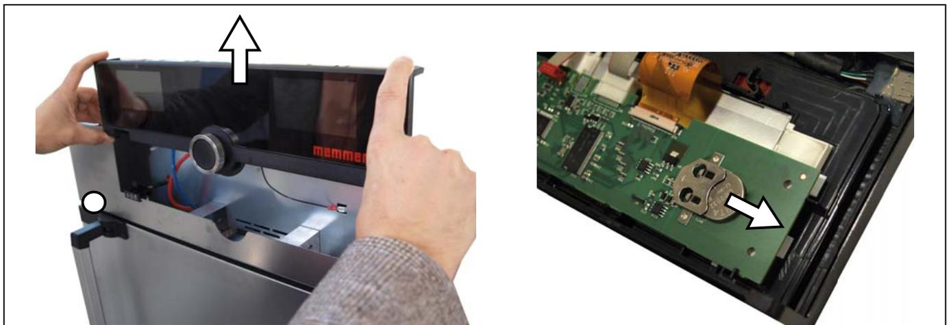
Fig. 29 Retirar la batería de litio
