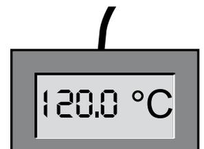
Con Cal1 se puede ajustar del mismo modo otra temperatura de compensación por debajo de Cal2 y con Cal3 una temperatura de compensación por encima. Entre los valores Cal debe existir una diferencia mínima de 20 K en las estufas universales UN/UF y de 10 K en los incubadores IN/IF.
