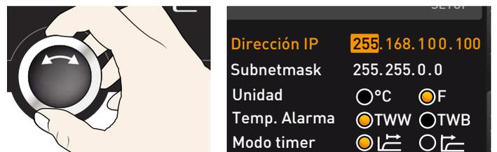
4. Acepte la selección con la tecla de confirmación. El siguiente bloque de cifras de la dirección IP se marca de forma automática. Este se puede ajustar de la misma forma que se acaba de describir.
