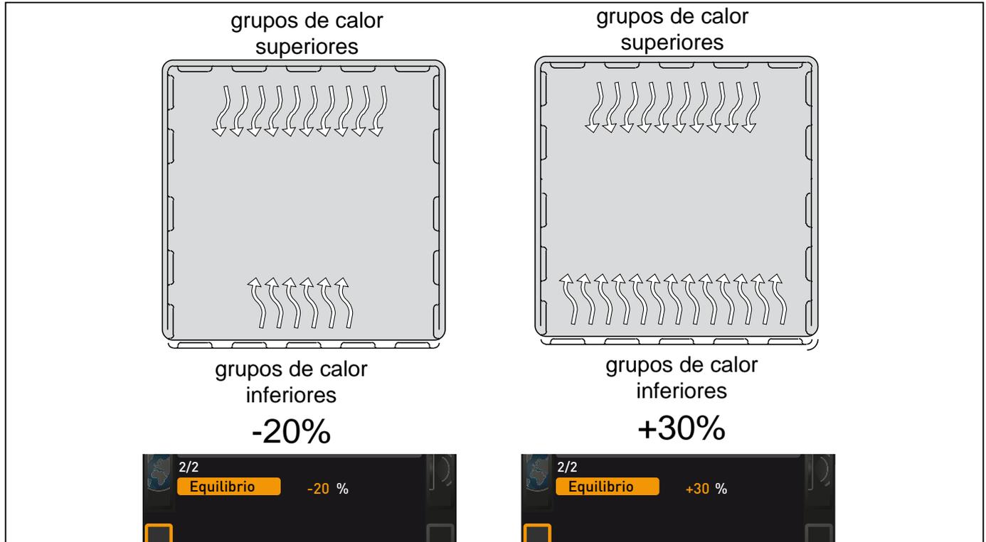
Fig. 26 Distribución de la potencia calorífica (ejemplo): el ajuste a  $-20\%$  (izquierda) da lugar a que los grupos de radiadores inferiores calienten con un 20% menos de rendimiento que los superiores. el ajuste a  $+30\%$  (derecha) da lugar a que los grupos de radiadores inferiores calienten con un 30% menos de rendimiento que los superiores. El ajuste a  $0\%$  restablece la distribución de la potencia calorífica de fábrica.
