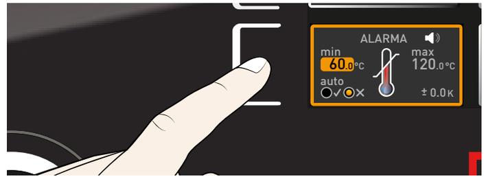
2. Ajuste el límite inferior de alarma deseado con el botón giratorio, en el ejemplo de la derecha 160 °C.
