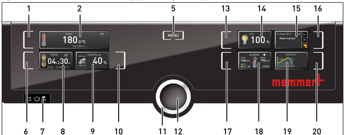
Fig. 17 ControlCOCKPIT de los equipos UNxxplus/INxxplus
