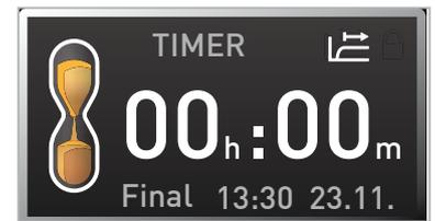
Para desactivar el temporizador, vuelva a acceder al modo de ajuste del temporizador presionando la tecla de activación, gire el botón giratorio hasta que el tiempo de funcionamiento sea --:-- y, a continuación, acepte con la tecla de confirmación.
