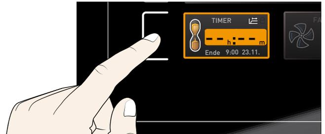
2. Gire el botón giratorio hasta visualizar el tiempo de funcionamiento deseado – (en el ejemplo, 4 horas y 30 minutos–). Debajo se muestra en menor tamaño la hora de finalización prevista según los cálculos.
