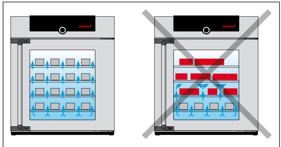
Fig. 15 Colocación correcta de la carga
