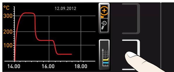
▶ Para cambiar el intervalo de tiempo mostrado: presione la tecla de activación junto a los símbolos de flecha <|>. A continuación puede desplazar el intervalo de tiempo del indicador con el botón giratorio.
