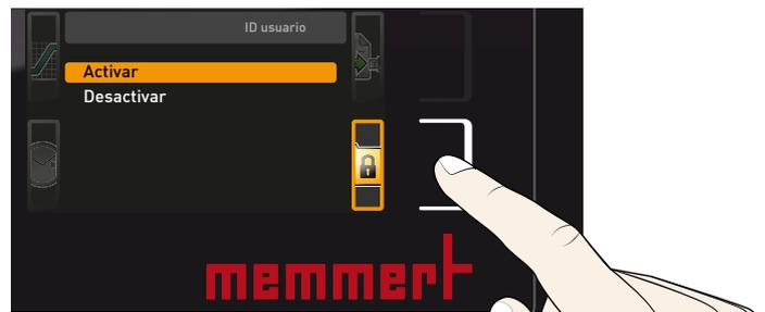
3. Confirme la activación presionando la tecla de confirmación. Los nuevos datos de ID de usuario se transmiten desde el dispositivo USB y se activan. Al finalizar la activación, se muestra una marca de verificación delante del campo.
