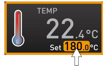
3. Guarde el valor configurado presionando la tecla de confirmación. El indicador vuelve al estado normal y el equipo inicia el proceso de ajuste conforme al valor configurado.
