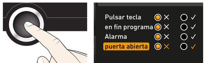
**i** Cuando suena una señal acústica, se puede apagar presionando la tecla de confirmación.
