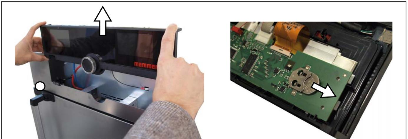
Abb. 34 Lithiumbatterie entfernen
