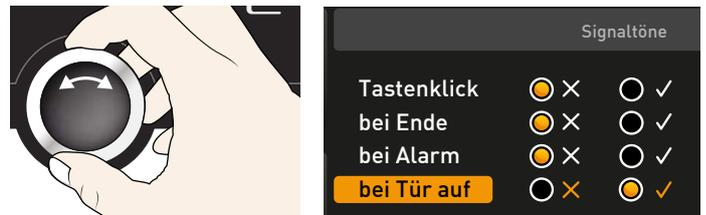
2. Auswahl durch Drücken der Bestätigungstaste bestätigen. Es werden automatisch die Einstellungsmöglichkeiten markiert.
