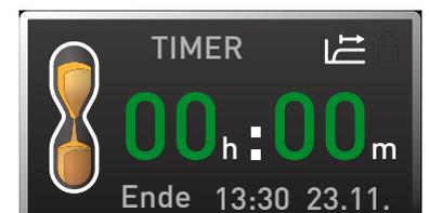
Zum Ausschalten des Timers die Timeranzeige durch Drücken der Aktivierungstaste erneut aufrufen, mit dem Drehknopf die Laufzeit so weit zurückdrehen, bis --:-- angezeigt wird, und mit der Bestätigungstaste übernehmen.
