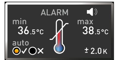
Wenn eine Temperaturüberwachung angesprochen hat, wird dies in der Temperaturanzeige angezeigt: durch die rot hinterlegte Isttemperatur und ein Alarmsymbol ⚠ (Abb. 21). Darunter wird angezeigt, welche Art Temperaturüberwachung angesprochen hat (in diesem Beispiel TWW).
