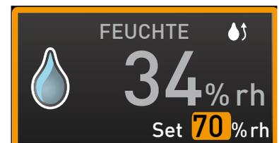
Hohe Luftfeuchtigkeit im Innenraum kann erst dann kondensationsfrei erreicht werden, wenn der Innenraum vollständig durchgewärmt ist. Aus diesem Grund wird die Annäherungsgeschwindigkeit an den Feuchte-Sollwert dynamisch in Abhängigkeit von der Innenraumtemperatur geregelt.
