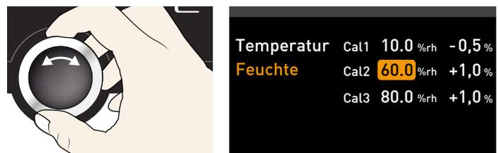
5. Einstellung durch Drücken der Bestätigungstaste speichern. Es wird automatisch der dazugehörige Abgleichkorrekturwert markiert.
