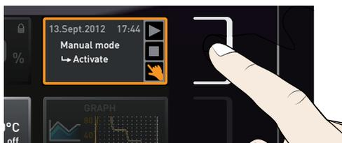
2. Ruotare la manopola fino a quando il simbolo dell'avvio ► appare evidenziata. Viene visualizzato il programma attualmente disponibile, nell'esempio Test 012.
