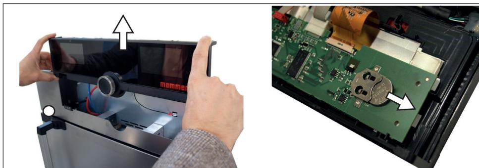
Fig. 29 Rimuovere la batteria al litio
