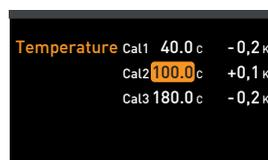
3. Con l'ausilio della manopola impostare la temperatura di compensazione Cal2 a 120° C.
