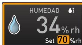
Los niveles altos de humedad del aire en la cámara interior solo se pueden lograr sin que haya condensación si la cámara de trabajo se ha calentado completamente. Por eso, la velocidad de la regulación dinámica para aproximarse al valor de humedad de referencia depende de la temperatura de la cámara de trabajo.
