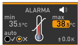
1. La temperatura de control debe ajustarse con suficiente margen sobre la temperatura nominal máxima. Se recomienda entre 1 y 3 K.
