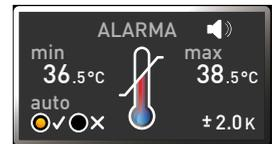
La reacción del sistema de vigilancia de la temperatura se muestra en el indicador de temperatura a través del valor de temperatura real resaltado sobre un fondo rojo y el símbolo de alarma
