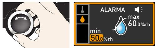
5. Acepte la selección con la tecla de confirmación. A continuación se resalta el límite superior de la alarma de humedad de forma automática.
