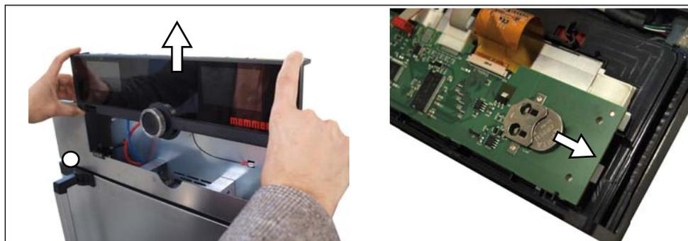
Fig. 35 Retirar la batería de litio
