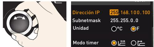
4. Acepte la selección con la tecla de confirmación. El siguiente bloque de cifras de la dirección IP se marca de forma automática. Este se puede ajustar de la misma forma que se acaba de describir.
