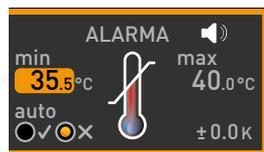
1. El límite inferior de alarma no se puede ajustar más alto que el superior. Si no se necesita ninguna protección contra temperatura inferior, ajuste la temperatura mínima.
