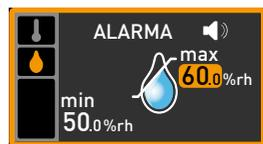
6. Ajuste el límite superior de alarma deseado con el botón giratorio, en el ejemplo de la derecha 70 % rh.
