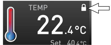
Fig. 33 Función de cambio del ajuste de temperatura en el equipo bloqueada (ejemplo)
