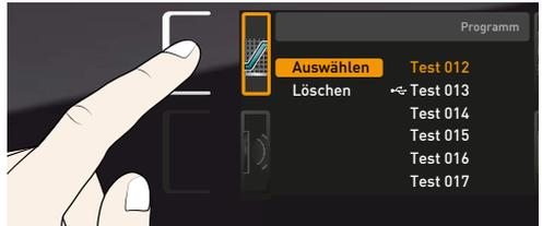
2. Funktion **Auswählen** durch Drücken der Bestätigungstaste aufrufen. Es werden alle verfügbaren Programme angezeigt, auch diejenigen, die sich auf dem USB-Datenträger befinden (erkennbar am USB-Symbol). Das derzeit zur Ausführung bereitstehende Programm ist orange hinterlegt.
