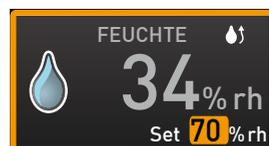
Hohe Luftfeuchtigkeit im Innenraum kann erst dann kondensationsfrei erreicht werden, wenn der Innenraum vollständig durchgewärmt ist. Aus diesem Grund wird die Annäherungsgeschwindigkeit an den Feuchte-Sollwert dynamisch in Abhängigkeit von der Innenraumtemperatur geregelt.
