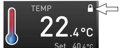
Abb. 33 Verstellen der Temperatur am Gerät gesperrt (Beispiel)
