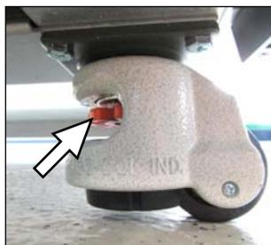
Abb. 9 Handrad zum Anheben des Geräts
