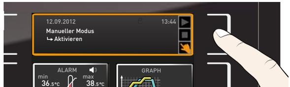
2. Drehknopf drehen, bis das Startsymbol ▶ markiert ist. Es wird das aktuell zur Verfügung stehende Programm angezeigt, in diesem Beispiel **Test 012**.
