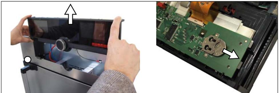
Abb. 35 Lithiumbatterie entfernen
