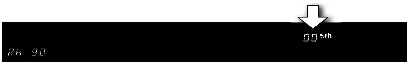
2. L'enceinte étant en équilibre sur l'humidité de consigne de 90, on mesure une humidité effective de 88 % h.r. à l'aide d'un instrument étalon.
