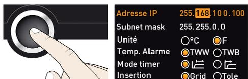
5. Après le paramétrage du dernier bloc de chiffres de la nouvelle adresse IP, confirmer à l'aide de la touche de validation. Le marquage apparaît de nouveau dans l'aperçu. Procéder de la même façon pour le réglage du masque de sous-réseau.
