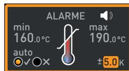
9. Appuyer sur la touche de validation pour confirmer. Le dispositif de sécurité thermique est maintenant activé.
