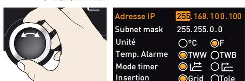
4. Accepter la sélection avec la touche de validation. Ceci sélectionne automatiquement le bloc de chiffres de l'adresse IP suivant. Régler également ce bloc comme indiqué ci-dessus, et ainsi de suite.
