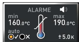
Dès que le dispositif de sécurité thermique est déclenché, cet évènement est signalé dans l'affichage de la température par la température effective indiquée en rouge et par un symbole d'alarme
