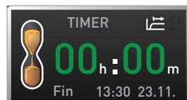
Pour désactiver le timer, appuyer sur la touche d'activation pour appeler de nouveau l'affichage du timer, ramener la durée du cycle à l'aide du bouton rotateur jusqu'à l'affichage --:-- et accepter avec la touche de validation.
