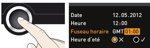
4. Avec le bouton rotateur, régler le fuseau horaire en fonction de la localisation de l'appareil, par ex., 00:00 pour la France, l'Espagne ou le Royaume-Uni, 01:00 pour l'Allemagne. Confirmer le réglage avec la touche de validation.
