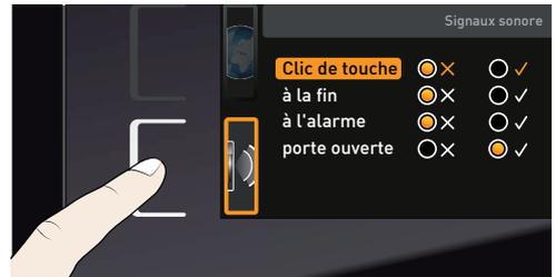
1. Si vous souhaitez modifier un autre élément de la liste : tourner le bouton rotateur jusqu'à ce que l'élément souhaité, par ex. porte ouverte (équipement spécial), soit sélectionné en orange.
