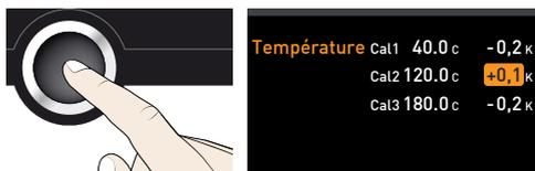
5. Régler le correctif d'étalonnage sur 0,0 K et enregistrer ce réglage en appuyant sur la touche de validation.
