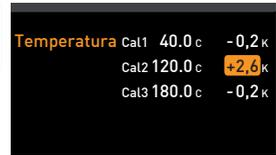
10. Después del proceso de regulación, la temperatura registrada por la sonda de referencia debería indicar ahora 120 °C.
