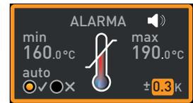
8. Ajuste la banda de tolerancia deseada con el botón giratorio, por ejemplo, 5.0 K.
