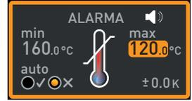
4. Ajuste el límite superior de alarma deseado con el botón giratorio, en el ejemplo de la derecha 190 °C.
