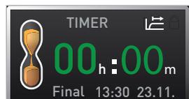
Para desactivar el timer, vuelva a acceder al modo de ajuste del timer presionando la tecla de activación, gire el botón giratorio hasta que el tiempo de funcionamiento sea --:-- y, a continuación, acepte con la tecla de confirmación.
