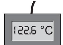
9. Ajuste en SETUP el valor de compensación de Cal2 a +2,6 K (el valor real registrado menos el valor nominal) y guarde la configuración presionando la tecla de confirmación.
