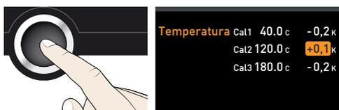
5. Ajuste el valor de compensación a 0,0 K y guarde la configuración presionando la tecla de confirmación.
