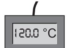
Con Cal1 se puede ajustar del mismo modo otra temperatura de compensación por debajo de Cal2 y con Cal3 una temperatura de compensación por encima. Entre los valores Cal debe existir una diferencia mínima de 20 K.
