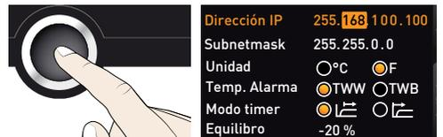
5. Cuando se termine la configuración del último bloque de cifras, acepte la dirección presionando la tecla de confirmación. La marca en color volverá a pasar a la vista general. La máscara de subred se puede ajustar de la misma forma.
