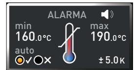
La reacción del sistema de vigilancia de la temperatura se muestra en el indicador de temperatura a través del valor de temperatura real resaltado sobre un fondo rojo y un símbolo de alarma ▲ (Fig. 20). Debajo se indica el tipo de control de temperatura que se ha activado (en el ejemplo TWW).
