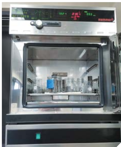
Drainage de carottes de forage en étuve à vide VO de Memmert Secado de los núcleos de perforación en la estufa de vacío VO de Memmert
