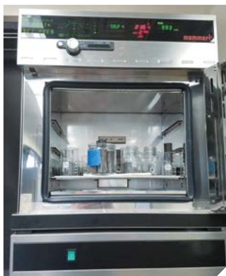
Trocknung der Bohrkern im Memmert Vakuumschrank VO Drying of drill cores in the Memmert vacuum oven VO
