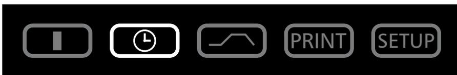
Dans ce mode, l'étuve fonctionne en mode temps hebdomadaire avec arrêt et mise en marche automatique sur les valeurs programmées.
