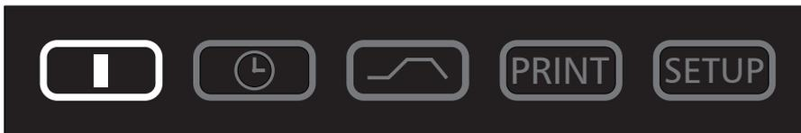
Dans ce mode, l'étuve fonctionne en continu, chauffe et régule sur la température de consigne. Les différentes sélections sont immédiatement répercutées sur le fonctionnement de l'étuve.
