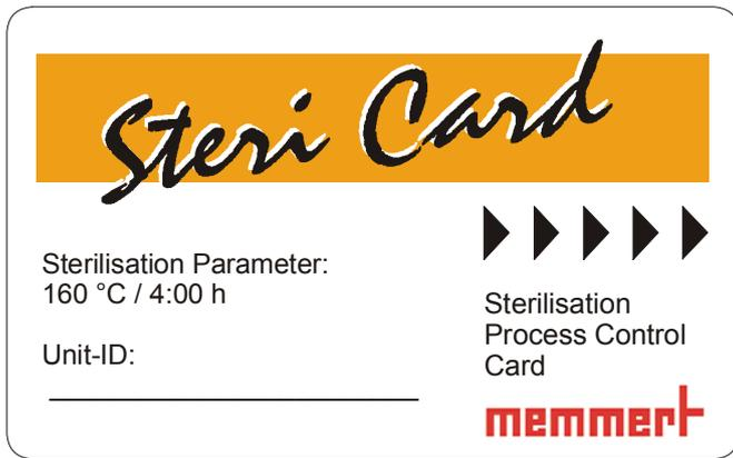
Para descontaminación, el HCP está equipado de serie con una STERICard. La STERICard inicia un proceso de esterilización automático predeterminado.
