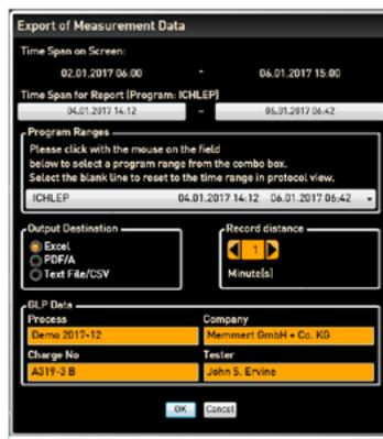
Quando si esportano protocolli è possibile selezionare settori del programma. I settori del programma sono i periodi di tempo dei programmi elaborati (profili) o le durate del "simple timer" (Fig. 19). Ogni settore del programma contiene il nome del programma e la relativa durata (ad es. "Programma test", 09:30 - 12:30). Se nella lista presente nella finestra di dialogo di esportazione si seleziona il campo vuoto, viene utilizzato il lasso di tempo indicato nella finestra del protocollo.
