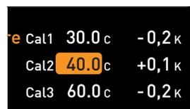
3. Utilizar o botão rotativo para ajustar a temperatura de compensação de Cal2 para 42°C.
