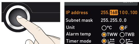
5. Quando o último conjunto de números estiver inserido, confirmar o novo endereço IP com o botão de confirmação. A marca volta para o separador Vista geral.
