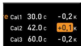
5. Ajustar a correção de compensação para 0,0 K e premir o botão de confirmação para guardar o ajuste.
