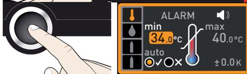
1. Utilizar o botão rotativo para ajustar o limite inferior pretendido do alarme, no exemplo à direita, 35,5 °C.
