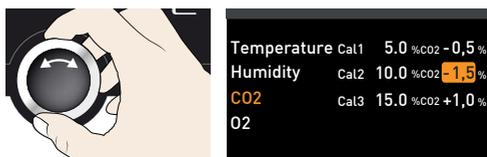
11. O valor de CO<sub>2</sub> medido pelo medidor de referência também deve ser de 10% após o procedimento de ajuste.
