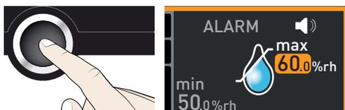
6. Utilizar o botão rotativo para ajustar o limite superior pretendido do alarme, no exemplo à direita, 70% RH.
