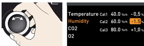
11. A humidade medida pelo medidor de referência também deve ser de 60% RH após o procedimento de ajuste.
