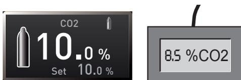
10. Ajustar a correção de compensação de Cal2 em SETUP para -1,5% (valor de referência medido menos o valor apresentado) e premir o botão de confirmação para guardar o ajuste.
