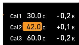
4. Premir o botão de confirmação para guardar o ajuste. A respectiva correção de compensação é automaticamente selecionada.
