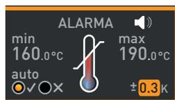
9. Ajuste la banda de tolerancia deseada con el botón giratorio, por ejemplo, 5.0 K.
