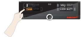
La reacción del sistema de vigilancia de la temperatura se muestra en el indicador de temperatura a través del valor de temperatura real resaltado sobre un fondo rojo y un símbolo de alarma
