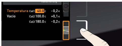
2. Presione la tecla de confirmación varias veces hasta que se resalte la temperatura de compensación Cal2.
