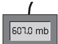
12. Ajuste en SETUP el valor de compensación de Cal2 a +7 mb (el valor real registrado menos el valor nominal) y guarde la configuración presionando la tecla de confirmación.
