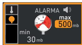
6. Ajuste el límite superior de alarma deseado con el botón giratorio, en el ejemplo de la derecha 600 mbar.
