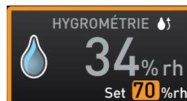
Pendant le chauffage de l'appareil, la vitesse d'approche d'hygrométrie est réglée de façon dynamique sur la valeur de consigne d'hygrométrie, et ce en fonction du point de rosée de la température du caisson intérieur.
