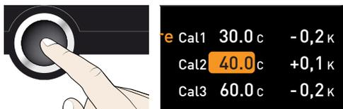
3. À l'aide du bouton rotateur, régler la température d'étalonnage Cal2 sur 42°C.
