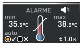
Dès que le dispositif de sécurité thermique est déclenché, cet événement est signalé dans l'affichage de la température par la température effective indiquée en rouge et par un symbole d'alarme ▲ (Ill. 17). Le dispositif de sécurité thermique responsable du déclenchement apparaît en dessous (dans cet exemple : TWW).
