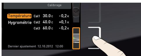
2. Appuyer sur la touche de validation jusqu'à ce que la température d'étalonnage Cal2 soit sélectionnée.
