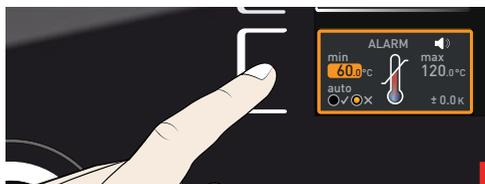
2. Utilizar o botão rotativo para ajustar o limite inferior pretendido do alarme, no exemplo à direita, 160 °C.
