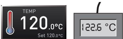
9. Ajustar a correção de compensação de Cal2 em SETUP para +2,6 K (valor real medido menos o valor nominal) e premir o botão de confirmação para guardar o ajuste.
