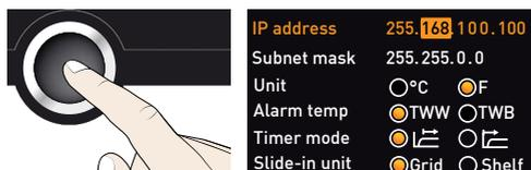
5. Quando o último conjunto de números estiver inserido, confirmar o novo endereço IP com o botão de confirmação. A marca volta para o separador Vista geral. A máscara de sub-rede é ajustada da mesma forma.
