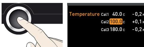
3. Utilizar o botão rotativo para ajustar a temperatura de compensação de Cal2 para 120 °C.
