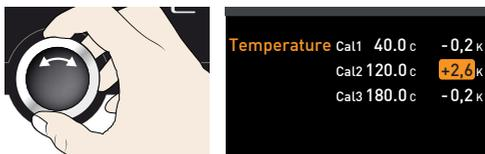
10. A temperatura medida pelo medidor de referência também deve ser de 120 °C após o procedimento de ajuste.
