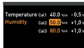
4. С помощью ручки настройки установите для точки регулировки Cal2 значение 60% ОВ.
