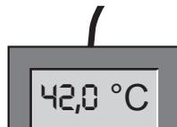
С помощью параметра Cal1 можно аналогичным образом настроить другое значение температуры компенсации ниже, а с помощью параметра Cal3 — выше Cal2. Минимальный интервал между значениями Cal составляет 10 К.
