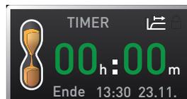
Para desligar o temporizador, aceda novamente à indicação de temporizador pressionando o botão de ativação, rode o temporizador para trás com a tecla rotativa até que seja exibido --:-- e confirme pressionando o botão de confirmação.
