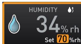
Só é possível atingir uma umidade elevada no espaço interno sem condensação quando ele estiver completamente aquecido. Por esta razão, a velocidade de aproximação ao valor nominal de umidade é controlada dinamicamente, dependendo da temperatura do espaço interno.
