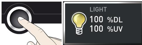
**i** Assim que os cartuchos de luz estiverem ativos, a unidade de refrigeração deve compensar o calor desperdiçado dos cartuchos de luz. Como tal, é possível apenas uma operação limitada de temperatura e umidade. É recomendada uma temperatura de 25 °C e uma umidade máxima de 50% de rh. Dependendo das condições ambientais, pode ocorrer condensação no espaço interno.
