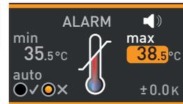
4. Assuma o limite de alarme superior pressionando o botão de confirmação. A configuração do controlador automático de temperatura (ASF) é ativada automaticamente (auto).
