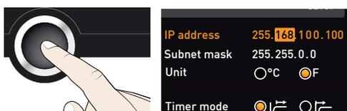
5. Depois de definir o último teclado numérico, confirme o novo endereço IP com o botão de confirmação. A marcação volta para a vista geral.
