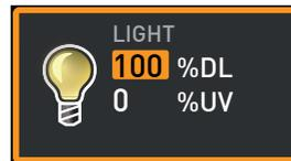
3. Salve a configuração pressionando o botão de confirmação. A entrada de raios UV (luz UV) é ativada automaticamente.
