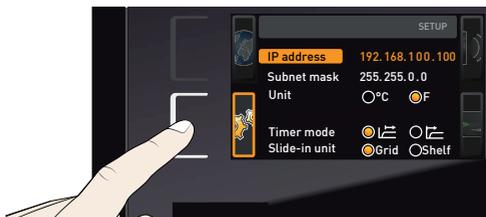
2. Confirme a seleção com o botão de confirmação. O primeiro teclado numérico do endereço IP é automaticamente marcado.
