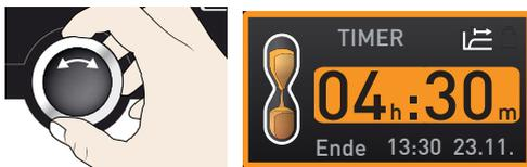
**i** A hora é apresentada em formato hh:mm (horas:minutos) até às 23 horas e 59 minutos e em formato dd:hh (dias:horas) após 24 horas. O tempo de execução máximo é de 99 dias e 00 horas.
