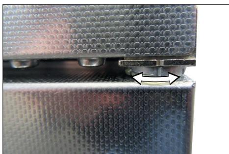
Fig. 18 Rotazione del collare del cuscinetto nella scanalatura
