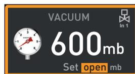
Se è impostato un campo di pressione inferiore a 5 mb, appare il messaggio LOW (basso). Il precedente valore effettivo viene mantenuto quando si preme il tasto OK. In modalità Low, la pompa per vuoto funziona al massimo e non c'è un controllo della pressione. La pressione raggiunta dipende solo dal vuoto finale della pompa.
