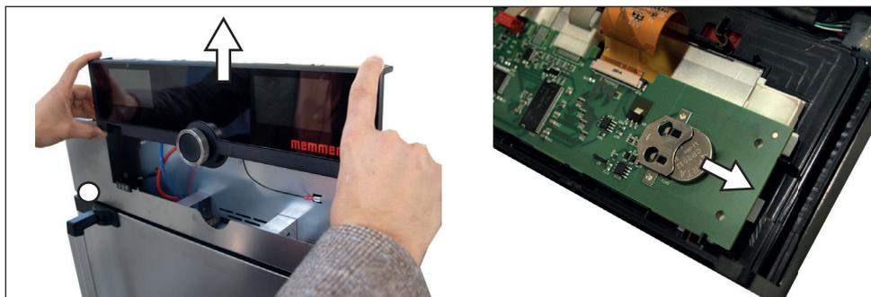
Fig. 41 Rimozione della batteria al litio
