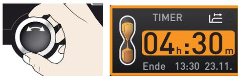
1. Fino a 23 ore 59 minuti il tempo è visualizzato nel formato hh:mm (ore:minuti), oltre le 24 ore diventa dd:hh (giorni:ore). Il tempo massimo è 99 giorni e 00 ore.
