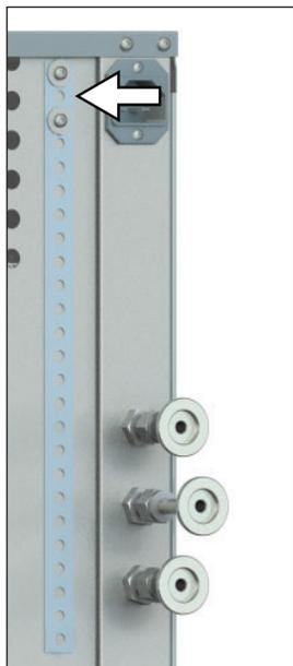
Fig. 14 Montaggio del dispositivo antiribaltamento sul pannello posteriore
