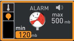
4. Con l'ausilio della manopola impostare il limite inferiore di allarme desiderato, nell'esempio a destra 30 mbar.
