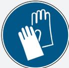
La valvola di scarico può surriscaldarsi durante lo svuotamento del bagnomaria. Il contatto con la sua superficie può causare ustioni. Utilizzare guanti protettivi termoresistenti per attivare/disattivare la valvola di scarico oppure lasciare prima raffreddare il mezzo di tempra e svuotare il bagnomaria quando ha raggiunto una temperatura tiepida.
