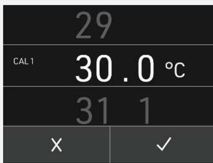
3. Faites défiler verticalement pour régler la température d'étalonnage **CAL1** à 30 °C.
