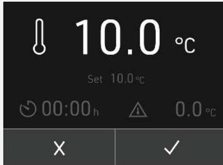
3. Sélectionnez la température de consigne, la durée de la minuterie et la température de l'alarme.
