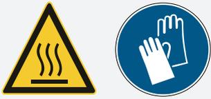
При опорожнении водяной бани сливной кран может перегреться. При контакте с его поверхностью возможно получение ожогов. Используйте термостойкие защитные перчатки для открытия/закрытия сливного крана или дайте теплопроводящей среде остыть до умеренно теплой температуры, прежде чем приступить к опорожнению водяной бани.
