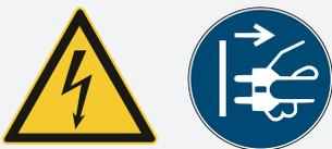
Перед снятием любых крышек необходимо извлечь вилку сетевого шнура из розетки. Выполнять работы внутри устройства разрешено только квалифицированным электрикам.
