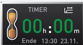
Wenn der Timer abgelaufen ist, zeigt die Anzeige 00h:00m. Alle Funktionen (Heizung usw.) werden abgeschaltet. Es ertönt zusätzlich ein akustisches Signal, das durch Drücken der Bestätigungstaste abgeschaltet werden kann.
