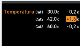
9. Ajuste en SETUP el valor de compensación de Cal2 a +1,6 K (el valor real registrado menos el valor nominal) y guarde la configuración presionando la tecla de confirmación.
