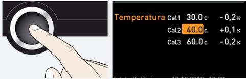
2. Presione la tecla de confirmación varias veces hasta que se resalte la temperatura de compensación Cal2.
