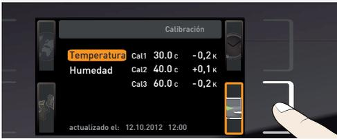
1. Presione la tecla de activación situada a la derecha del indicador de CALIB. El indicador se amplía y el campo de ajuste de rectificación de la temperatura se resalta automáticamente.
