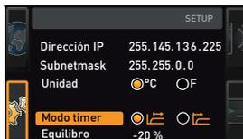
Con este ajuste se puede definir si el reloj de cuenta atrás digital con indicación del valor nominal (temporizador, apartado 5.3.2) debe funcionar según los valores nominales, es decir, si el tiempo de funcionamiento con temporizador no debe empezar a contar hasta alcanzar una banda de tolerancia de  $\pm 3$  K con respecto a la temperatura nominal (B), o si debe hacerlo ya inmediatamente después de la activación del temporizador (A).
