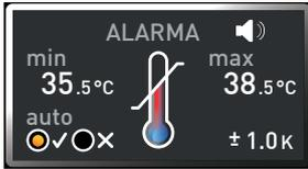
La temperatura de control del sistema de vigilancia electrónica de temperatura se mide en la cámara de trabajo mediante una sonda de temperatura Pt100 independiente. Los ajustes del sistema de vigilancia de temperatura se realizan en el indicador ALARMA. Las configuraciones se aplican en todos los modos de operación del equipo.
