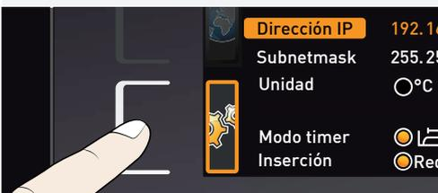
1. Active el indicador Configuración. El campo Dirección IP se marca de forma automática.
