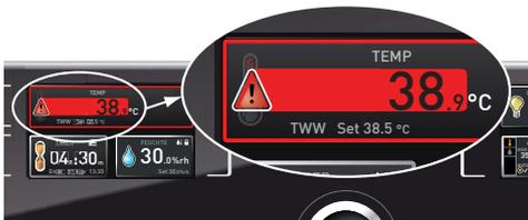
La reacción del sistema de vigilancia de la temperatura se muestra en el indicador de temperatura a través del valor de temperatura real resaltado sobre un fondo rojo y el símbolo de alarma . Debajo se indica el tipo de control de temperatura que se ha activado.
