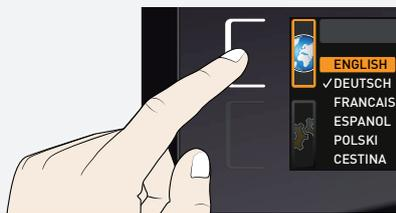
1. Active el ajuste deseado (en el ejemplo idioma). Para ello, presione la tecla de activación situada a la izquierda o a la derecha del indicador correspondiente. El indicador activado se amplía.
