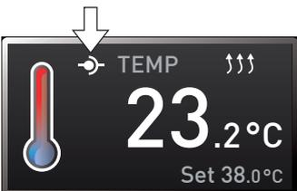
Si el equipo está en el modo de funcionamiento con telecommando, se muestra el símbolo
