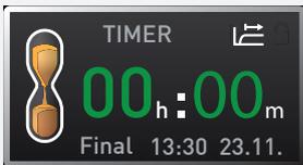
Al finalizar el tiempo del temporizador, en el indicador se muestra 00h:00m y se apagan todas las funciones (calefacción, etc.). Adicionalmente suena una señal acústica que puede apagarse presionando la tecla de confirmación.
