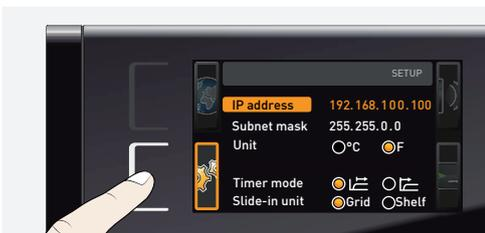
1. Ative o display SETUP. A entrada Endereço IP é automaticamente destacada.
