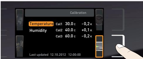
1. Pressione a tecla de ativação à direita do display "CALIB". O display é ampliado e a opção de ajuste de temperatura é selecionada automaticamente.
