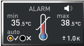
A temperatura de monitoramento do monitoramento eletrônico de temperatura é medida por meio de um sensor de temperatura PT100 separado na câmara. As configurações de controle de temperatura são feitas através da tela "ALARM" (ALARME). As configurações feitas se aplicam a todos os modos de operação.
