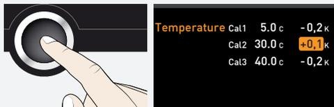
4. Salve a configuração pressionando o botão de confirmação. O valor de calibração correspondente é automaticamente destacado.
