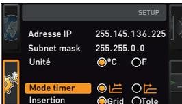
On peut régler ici l'horloge numérique avec définition du temps d'attente (timer, chapitre 5.3.2) pour qu'elle travaille en fonction de la valeur de consigne ou pas – c'est-à-dire lancer le démarrage de la minuterie lorsqu'une bande de tolérance de  $\pm 3$  K à la température désirée est atteinte (B) ou immédiatement après l'activation de la Minuterie (A).
