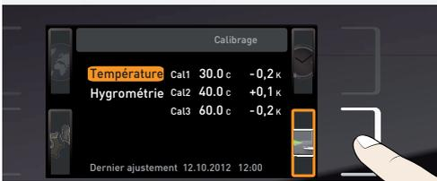
1. Appuyer sur la touche d'activation à droite de l'affichage CALIB. L'affichage s'agrandit et la commande ajustement de la température est automatiquement sélectionnée.
