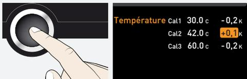
4. Appuyer sur la touche de validation pour enregistrer le réglage. La valeur corrective d'étalonnage correspondante est automatiquement indiquée.
