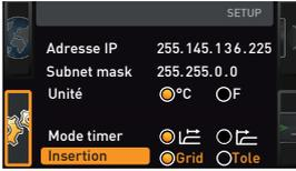
Il s'agit ici de paramétrer le type d'insertion (grid en acier ou shelf) utilisé. La sélection Shelf permet d'adapter la fonction de réglage aux différents comportements de flux au sein du caisson lors de l'utilisation de plateaux disponibles en option au lieu des grids en acier fournis en standard.
