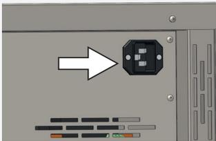
Respectez les réglementations spécifiques à chaque pays lorsque vous effectuez des raccordements (par exemple, DIN VDE 0100 avec disjoncteur différentiel de fuite à la terre, en Allemagne). Tenez compte des valeurs d'intensité et de puissance (voir la plaque signalétique et les chapitres « Spécifications techniques » 2.7 and 2.8). Vérifiez l'intégrité de la mise à la terre de protection du raccordement.
