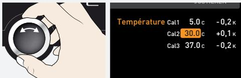
3. À l'aide du bouton rotateur, régler la température d'étalonnage Cal2 sur 30 °C.
