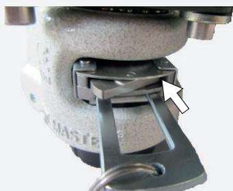
La direction du mouvement (haut/bas) peut être réglée à l'aide de la bascule située au-dessus du levier à cliquet :
