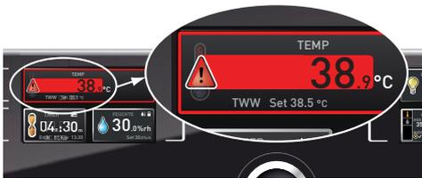
Dès que le dispositif de sécurité thermique est déclenché, cet événement est signalé dans l'affichage de la température par la température effective indiquée en rouge et par un symbole d'alarme . Le dispositif de sécurité thermique responsable du déclenchement apparaît en dessous.
