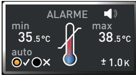
La température d'intervention du dispositif de sécurité thermique électronique est mesurée à l'aide d'une thermosonde PT100 indépendante à l'intérieur du caisson. Les réglages du dispositif de sécurité thermique sont effectués dans l'affichage ALARME. Les réglages effectués sont pris en compte dans tous les modes de fonctionnement.
