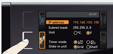
1. Активируйте меню SETUP. Пункт IP address (IP-адрес) автоматически выделяется.
