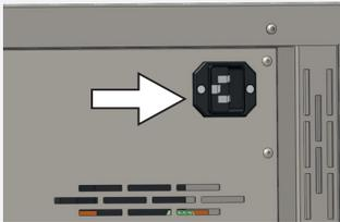
При электрическом подключении следует соблюдать принятые в стране стандарты (например, в Германии DIN VDE 0100 со схемой защитного отключения). Соблюдайте требования к подключению и номинальной мощности (см. фирменную табличку и технические данные в главах 2.7 и 2.8). Убедитесь в правильности подключения провода защитного заземления.
