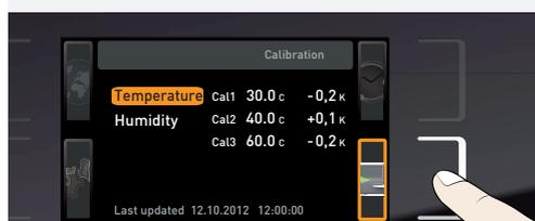
1. Нажмите кнопку активации рядом с индикатором CALIB. Индикатор будет увеличен, и на нем будет автоматически выделена опция регулировки температуры.
