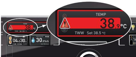
После запуска контроля температуры на дисплее отображается фактическая температура (красным цветом) и символ предупреждения **!** Под значением температуры отображается тип включенного контроля температуры.
