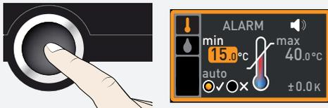
Salve a seleção pressionando o botão de confirmação. A configuração mín. (proteção contra subtemperatura) é ativada automaticamente.
