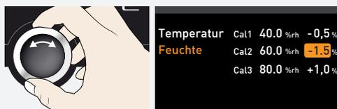
10. No SETUP, ajuste o valor de correção de compensação Cal2 para -1,5% (valor real medido menos a temperatura nominal) e salve a configuração pressionando o botão de confirmação.
