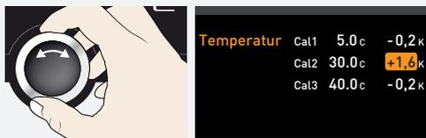
9. No SETUP, ajuste o valor de calibração Cal2 para +1,6 K (valor real medido menos temperatura nominal) e salve a configuração pressionando o botão de confirmação.
