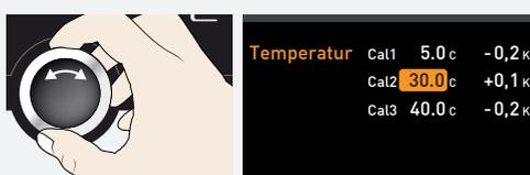
3. Com a tecla rotativa, defina a temperatura de calibração Cal2 para 30 °C.
