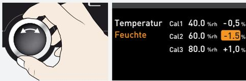
10. Nel menu SETUP (impostazione), regolare il valore di correzione della compensazione Cal2 a -1,5% (valore effettivo misurato meno temperatura nominale) e salvare le impostazioni premendo il tasto OK.
