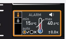
1. Appuyer sur la touche d'activation à gauche de l'affichage ALARM. Le réglage du dispositif de sécurité thermique est automatiquement activé.
