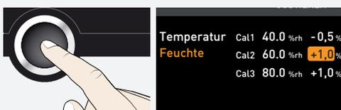
5. Appuyer sur la touche de validation pour enregistrer le réglage. La valeur corrective d'étalonnage correspondante est automatiquement indiquée.
