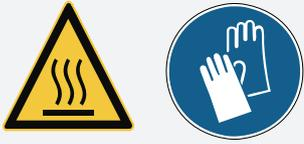
Durante il funzionamento dell'agitatore, i singoli componenti possono riscaldarsi. Il contatto con la sua superficie può causare ustioni. Utilizzare guanti protettivi termoresistenti.
