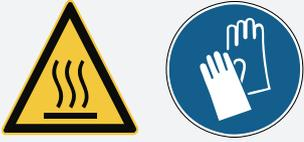
**Durante il funzionamento dell'unità di raffreddamento, i singoli componenti possono riscaldarsi. Il contatto con la sua superficie può causare ustioni. Utilizzare guanti protettivi termoresistenti.**
