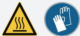
A seconda della modalità di funzionamento, le superfici interne dell'apparecchio e il carico possono essere molto caldi anche dopo che l'apparecchio è stato spento. Pertanto, in caso di contatto accidentale si possono riportare ustioni. Utilizzare sempre guanti protettivi termoresistenti o spegnere l'apparecchio e attendere che si raffreddi completamente prima di toccarlo.
