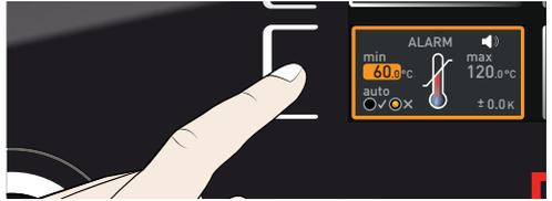
1. 使用旋钮设置所需的报警下限值，在右侧示例中为 35.5 °C。
