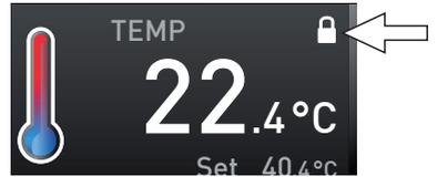
插图 24 禁用设备的温度调节（示例）
