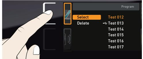
2. 按下确认按钮打开选择功能。显示所有可用的程序，包括 USB 数据载体上的那些程序（通过 USB 图标可辨认）。此时以备执行的程序标记为橙色。
