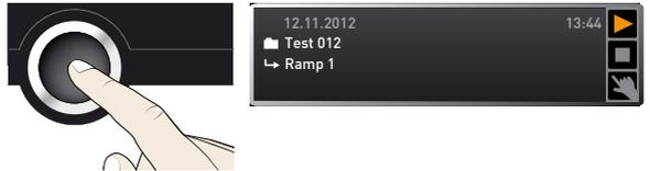
**1** 在程序运行时，无法修改设备上的参数（比如温度）。另外仍可操作，但显示 ALARM 和 GRAPH。
