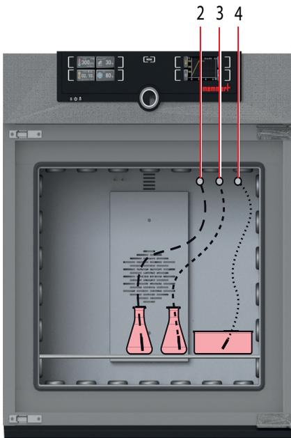
Flexibel im Innenraum bzw. Beschickungsgut zu positionierender Pt100-Tempersensor zur Vor-Ort-Temperaturmessung (maximal 3 zusätzliche Sensoren sind möglich). Die jeweils gemessenen Temperaturen werden im integrierten Datenspeicher protokolliert und im Display am ControlCOCKPIT angezeigt (T2, T3 usw.):
