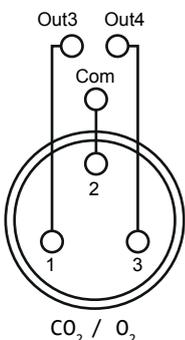
Schaltkontakt „Out 3“ für SMS-Mitteilung sendet SMS bei folgenden Fehlern:
