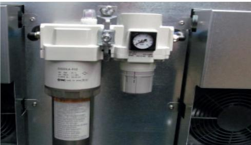
Über die Software des Geräts regelt ein Magnetventil den benötigten Luftstrom für die gewünschte Entfeuchtung. Eine manuelle Regelung an der Drucklufttrocknungseinheit ist nur unter extremen Prozessbedingungen notwendig.
