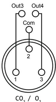
El contacto de conmutación «Out 3» envía un mensaje SMS cuando se producen los siguientes errores:
