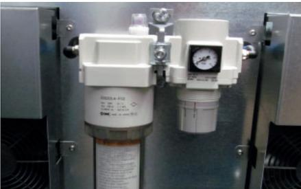
Una válvula solenoide regula el flujo de aire requerido para la deshumidificación deseada a través del software del equipo. Un ajuste manual de la unidad de secado con aire comprimido solo es necesario en condiciones de proceso extremas.
