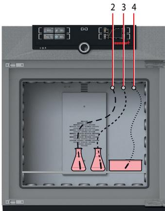
Sonda de temperatura Pt100 con distintas posibilidades de ubicación en el interior o en la carga para medición de la temperatura «in situ» (es posible añadir hasta 3 sondas más). Las temperaturas medidas son protocolizadas en la memoria interna de datos y mostradas en la pantalla del ControlCOCKPIT (T2, T3, etc.):
