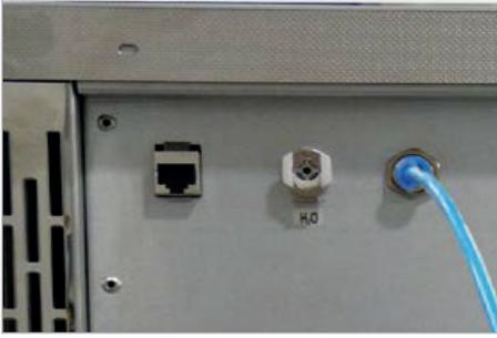
С обратной стороны устройства находится патрубок для подсоединения модуля осушения сжатым воздухом.
