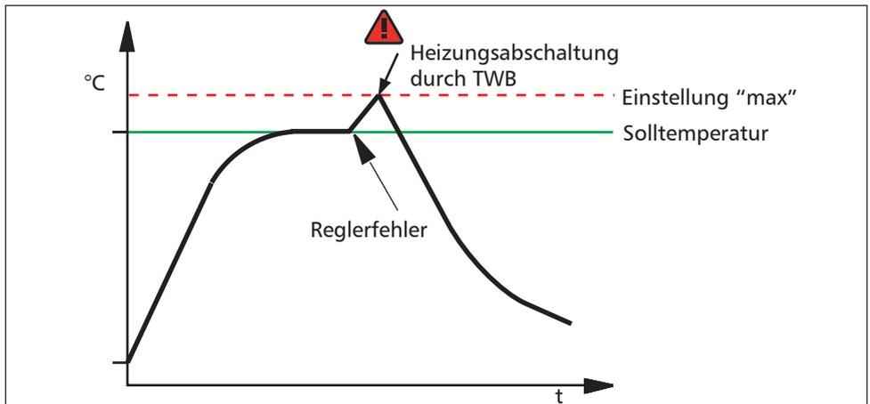
Abb. 19 Schematische Darstellung Funktionsweise TWB-Temperaturüberwachung
