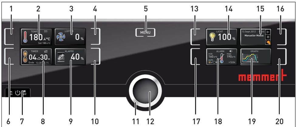
Abb. 15 ControlCOCKPIT von Geräten UF.../IF... im Betriebsmodus (Breite kann je nach Gerätegröße abweichen)
