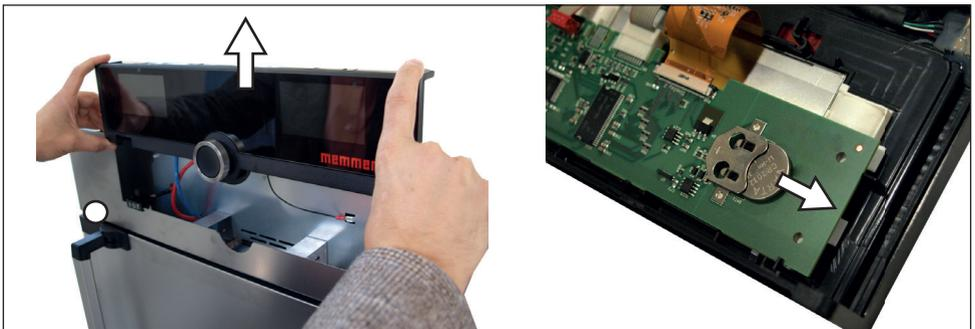
Abb. 28 Lithiumbatterie entfernen
