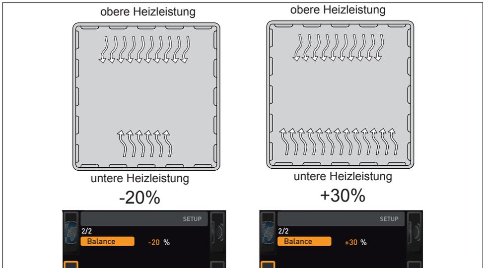
Abb. 25 Heizleistungsverteilung (Beispiel): Die Einstellung  $-20\%$  (links) bewirkt, dass die unteren Heizgruppen mit  $20\%$  weniger Leistung heizen als die oberen. Die Einstellung  $+30\%$  (rechts) bewirkt, dass die unteren Heizgruppen mit  $30\%$  mehr Leistung heizen als die obere. Die Einstellung  $0\%$  stellt die werkseitige Heizleistungsverteilung wieder her.
