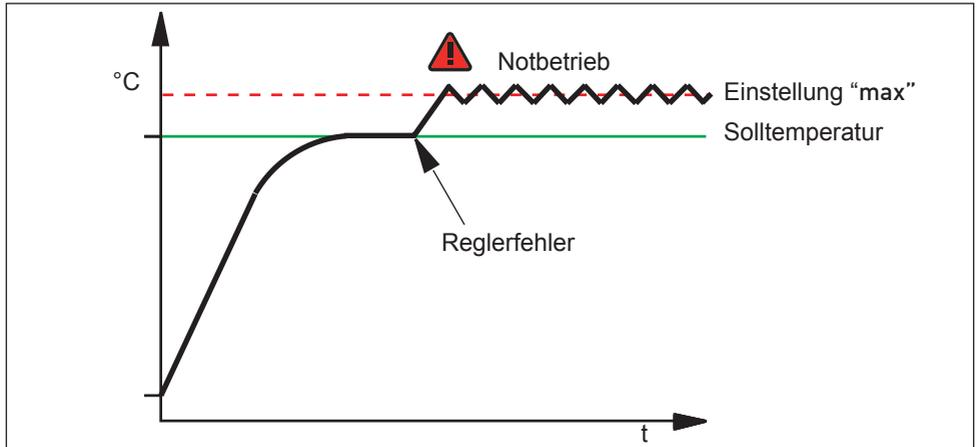
Abb. 18 Schematische Darstellung Funktionsweise TWW-Temperaturüberwachung
