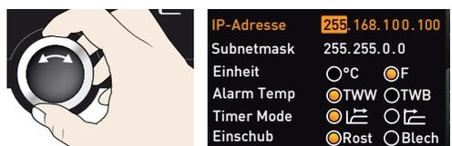
4. Auswahl mit der Bestätigungstaste bestätigen. Es wird automatisch der nächste Ziffernblock der IP-Adresse markiert. Auch dieser kann nun wie beschrieben eingestellt werden usw.
