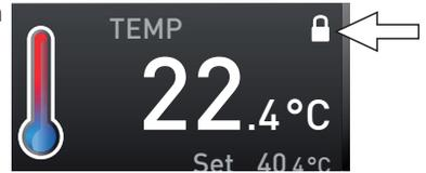
Abb. 27 Verstellen der Temperatur am Gerät gesperrt (Beispiel)
