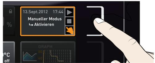
2. Drehknopf drehen, bis das Startsymbol ▶️ markiert ist. Es wird das aktuell zur Verfügung stehende Programm angezeigt, in diesem Beispiel Test 012.
