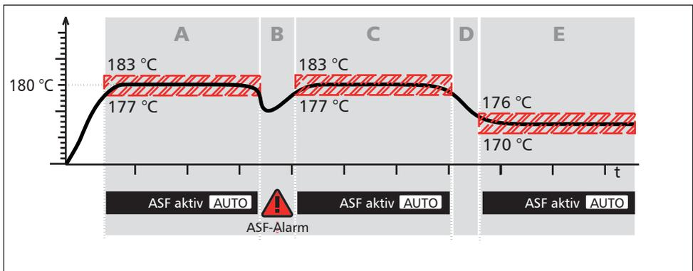
Abb. 20 Schematische Darstellung Funktionsweise ASF-Temperaturüberwachung
