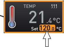
8. Warten, bis das Gerät die Solltemperatur erreicht hat und 120 °C anzeigt. Das Referenzmessgerät zeigt angenommen 122,6 °C.
