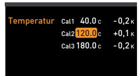
4. Einstellung durch Drücken der Bestätigungstaste speichern. Es wird automatisch der dazugehörige Abgleichkorrekturwert markiert.
