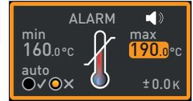
5. Oberen Alarmgrenzwert durch Drücken der Bestätigungstaste übernehmen. Es wird automatisch die Einstellung des automatischen Temperaturwächters (ASF) aktiviert (auto).
