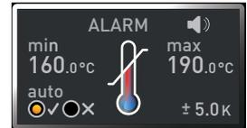
Wenn eine Temperaturüberwachung angesprochen hat, wird dies in der Temperaturanzeige angezeigt: durch die rot hinterlegte Isttemperatur und ein Alarmsymbol
