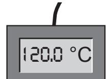
Mit Cal1 kann auf dieselbe Weise eine weitere Abgleichtemperatur unterhalb von Cal2 justiert werden, mit Cal3 eine darüberliegende. Der Mindestabstand zwischen den Cal-Werten beträgt bei Universalschränken UN.../UF... 20 K und bei Brutschränken IN.../IF... 10 K.
